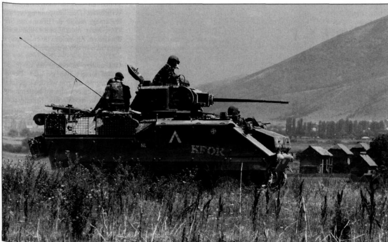
De Grenadiers en Jagers traden in Kosovo op als gemechaniseerde eenheid, uitgerust met de YPR-765
