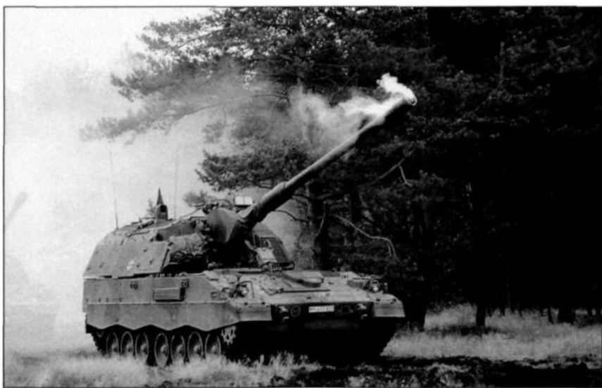
Met de introductie van de PanzerHaubitze 2000 worden alle bestaande houwitser, raketsystemen en zware mortieren (m.u.v. de zware mortieren van 11 AMB) vervangen door een moderne gemechaniseerde houwitser. De PanzerHaubitze beschikt over bescherming, tactische mobiliteit, een grote reikwijdte en een indrukwekkende nauwkeurigheid en vuursnelheid.
