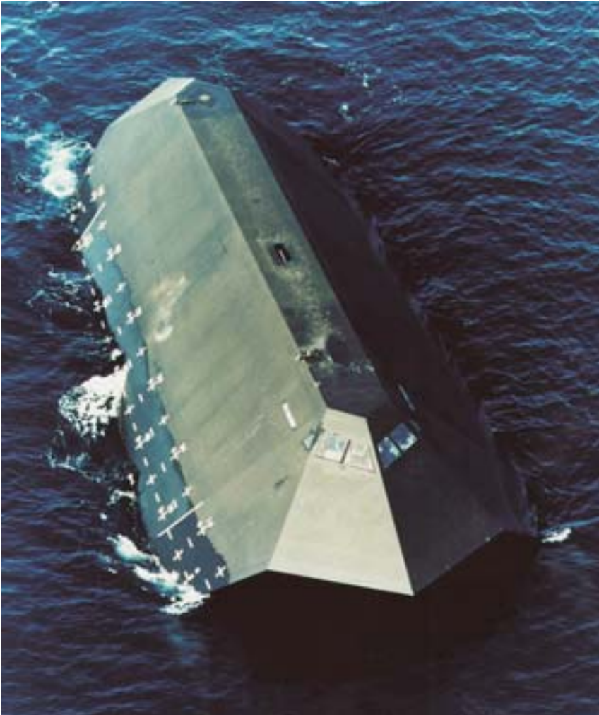
uss Sea Shadow. Experimenteel ontwerp ter reducering van radarreflectie (Bron: http://www.nawcwpns.navy.mil )
