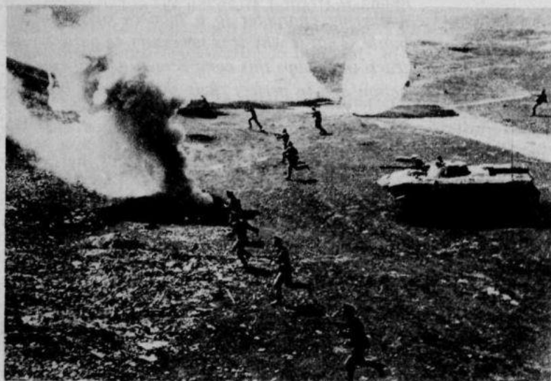
Afb. 16 De hoofdmacht is geland; de BMD (boiewaia mashina desanta) is uitgerust met een 73 mm kanon, een coaxmitrailleur, twee boegmitrailleurs en een Sagger (antitank) afvuurinstallatie op de loop van het kanon
