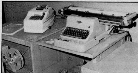
Afb. 10 Saldo Quick boekhoudmachine met gekoppelde telmachine en ponsbandapparatuur, in gebruik van 1955 tot 1975
