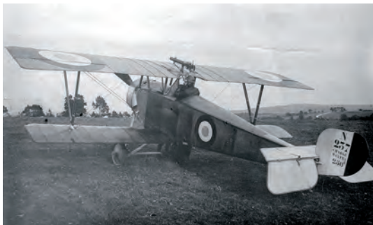
Het lichte en wendbare Nieuport XI Bébé jachtvliegtuig stelde de geallieerden in staat bij Verdun en aan de Somme het lucht-overzicht te veroveren. De mitrailleur is op de bovenzijde gemonteerd
