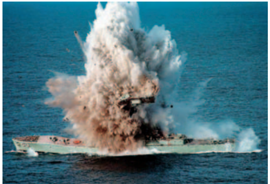
Het effect van één torpedo-inslag op een fregat
