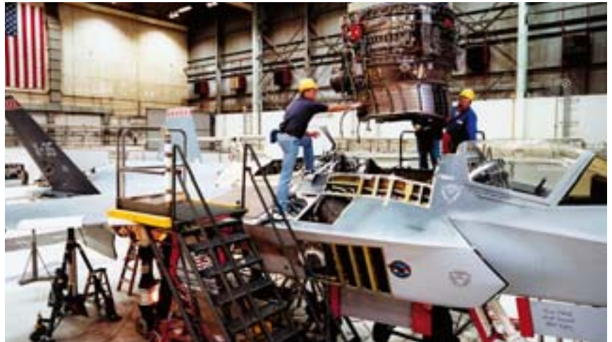
Installatie van de lift fan bij een Lockheed Martin X-35B JSF (Foto P.A. Torres)
