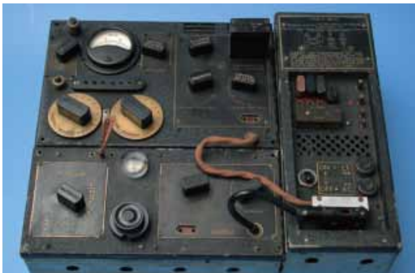
Een kofferzet 3 MK II, ontworpen door majoor J. Brown, Royal Signals. Door geallieerde agenten gebruikt van 1942-1945
