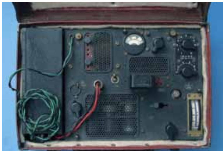
Een kofferset A MK III (fabrikaat Marconi) is door geallieerde agenten gebruikt van 1942-1945 (Foto F. Veltman, Museum Verbindingsdienst)
