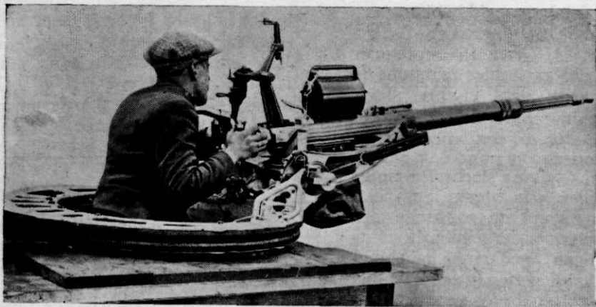
Afb. 3a. Geïmproviseerde voorstelling van de wijze, waarop een bewegelijk automatisch kanon van 20 mm Oerlikon model „L” in een vliegtuig wordt ingebouwd.
