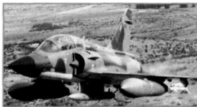
Mirage 2000N met ASMP-nucleaire missies (bevestigd aan middenpilon)
