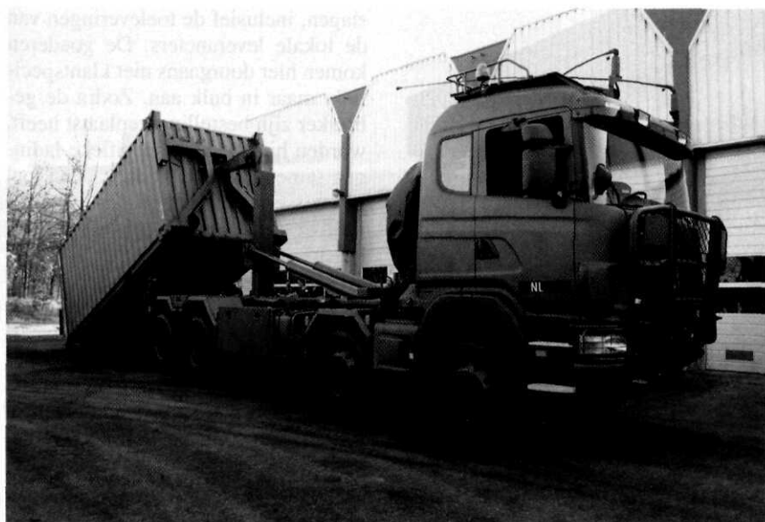
De firma's Daimler-Benz en Scania hebben beide een wissellaadsysteem voor containers bedacht. De Scania geeft een demonstratie
