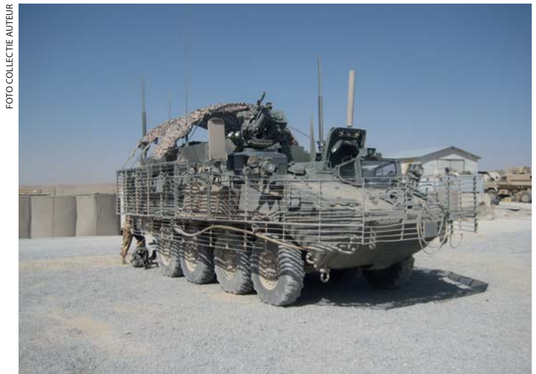
De Stryker is een onder licentie verbeterde versie van de MOWAG Piranha III met kenmerken als aanvullende bescherming, een onbemand en op afstand bedienbaar wapenstation en een grote dichtheid aan command & control middelen. Sommige voertuigen waren uitgerust met een 105 mm kanon en fungeerden als mobile gun system (MGS)
