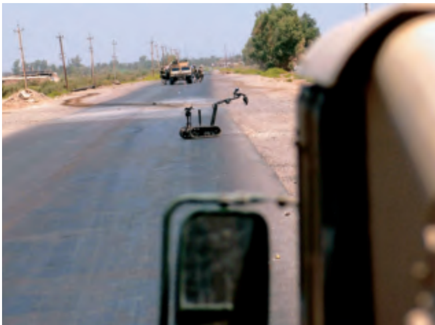
Een Amerikaanse Explosieven Opruimingsdienst gebruikt een Talon 3B-robot om geïmproviseerd explosief materiaal uit de weg te ruimen, Irak, 2005 (Foto U.S. Air Force, R.E. Cooley IV; collectie NIMH)
