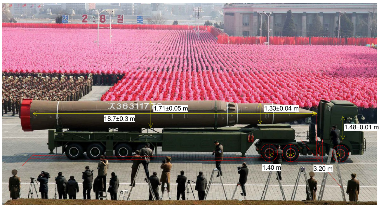
De Hwasong-14 op een Chinese Sinotruk HOWO T7H. Door de lengte van de raket te schalen met de wielbasis en de diameter met de hoogte van de cabine, worden de afmetingen van de raket bepaald.
