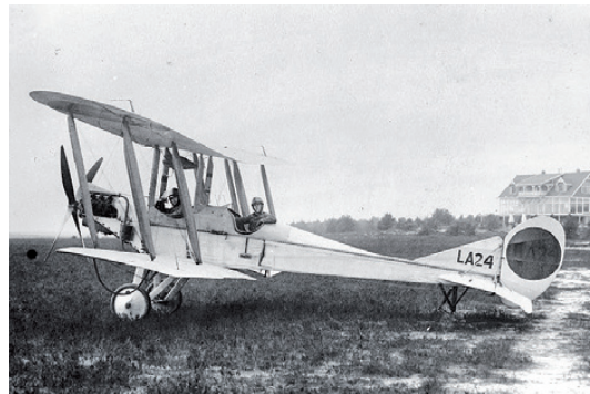
De op grote schaal door het Royal Flying Corps gebruikte fragiele BE.2c-tweedeekkers waren een gemakkelijke prooi voor de Fokker-jagers. Dit exemplaar werd in ons land geïnterneerd
