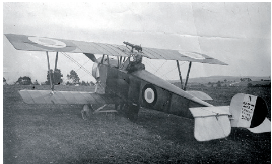
Het lichte en wendbare Nieuport XI Bébé jachtvliegtuig stelde de geallieerden in staat bij Verdun en aan de Somme het lucht-overzicht te veroveren. De mitrailleur is op de bovenvleugel gemonteerd
