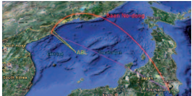
Figuur 1 Onderschepping van een No-dong uit Noord Korea op een afstand van 350 kilometer. De dikke rode lijn is de baan van de raket. De lila lijn is de projectie van de baan op de aarde. De zichtlijnen waartussen de ABL de raket kan onderscheppen zijn in geel weergegeven 16
